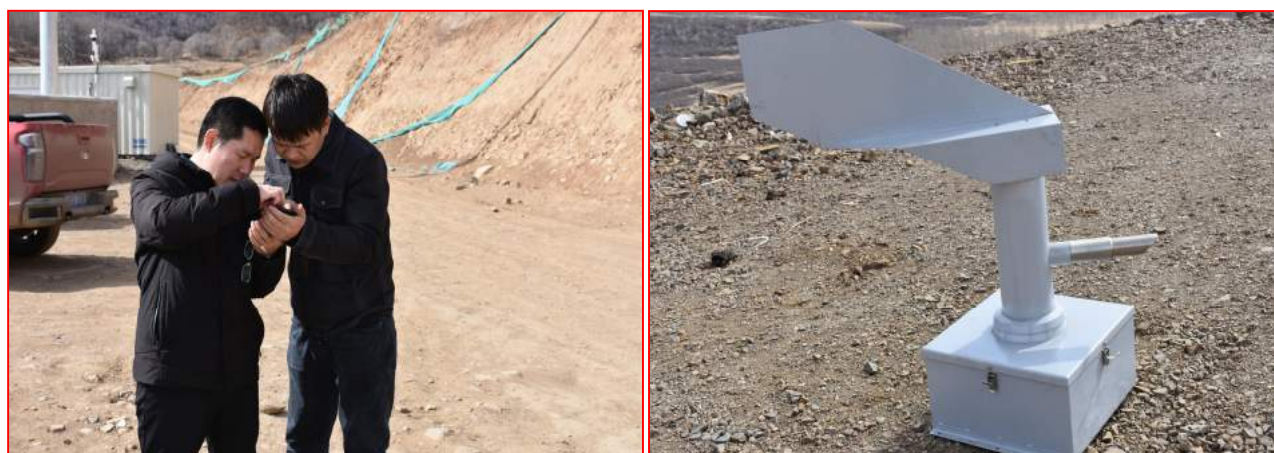
了解工程进展情况，积沙仪测风蚀（2023年3月）
