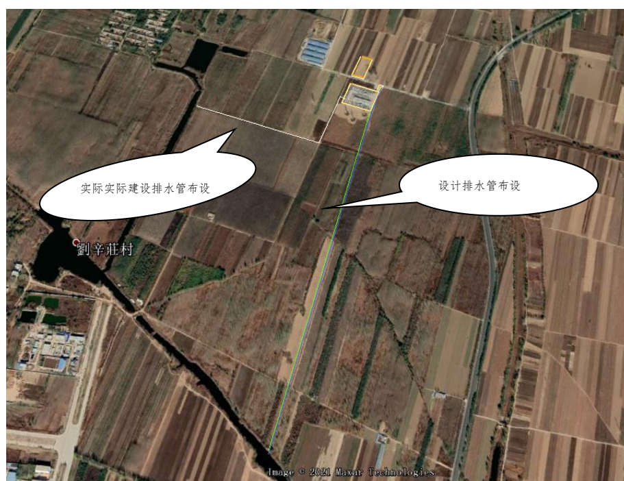
图 4-1 排水管道设计施工对比图
