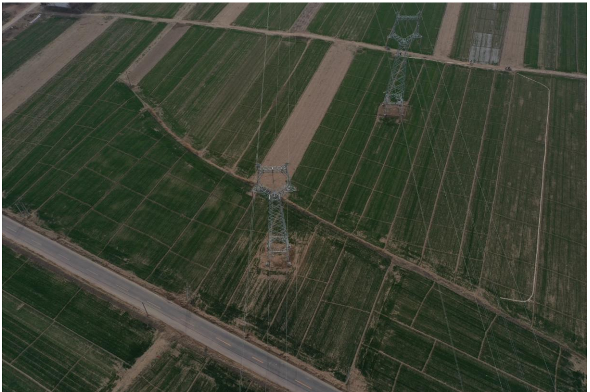
线路塔基区已平整，临时占地已复耕
